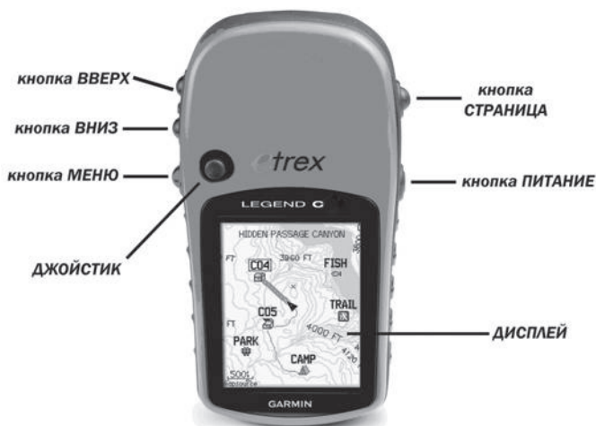
Рис. 13. Внешний вид (устройство) GPS-навигатора GARMIN eTrex Legend C
