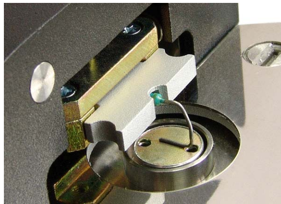
Рис. 2-10. Подключение эталонного резистора
