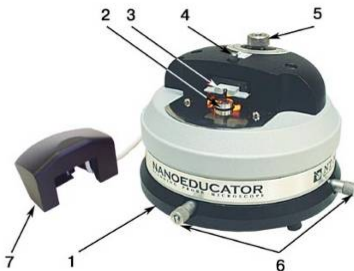
Рис. 1-10. (а) Внешний вид измерительной головки СЗМ NanoEducator 1 – основание, 2 – держатель образца, 3 – Датчик взаимодействия, 4 – винт фиксации датчика, 5 – винт ручного подвода, 6 – винты перемещения сканера с образцом, 7 – защитная крышка с видеокамерой
