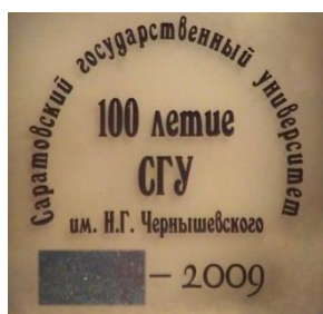
Рис. 3. Фотография пластины с юбилейным знаком СГУ, фрагмент которого покрыт слоем графита
