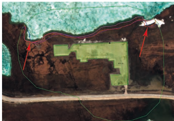
Рис. 2. Положение береговой линии озера без названия, расположенного в зоне влияния площадки КГС-26 в разные годы. Синий – 1989 г., красный – 2003 г., фиолетовый – 2009 г.
