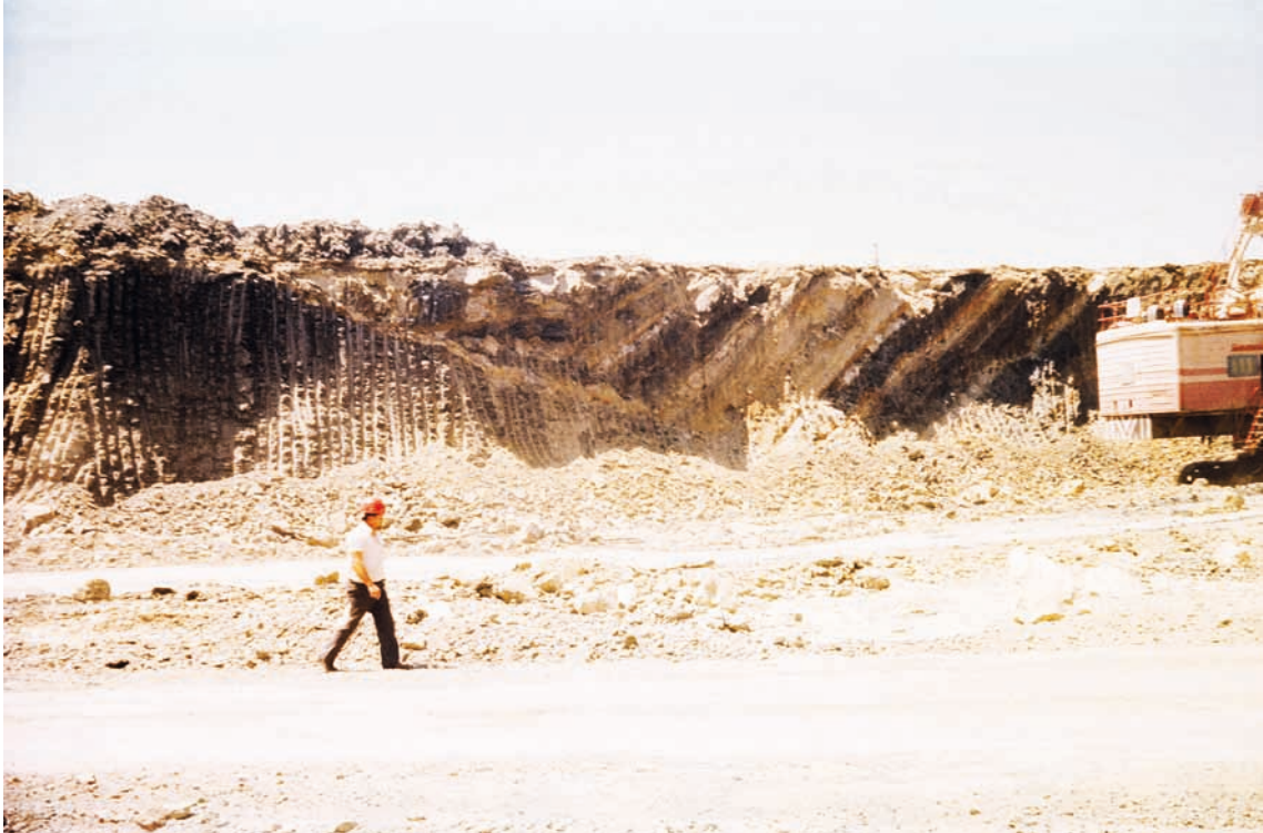
Рис. 1. Погребенные сейсмогравитационные дислокации в отложениях олигоцена, обнаруженные в результате вскрышных работ
