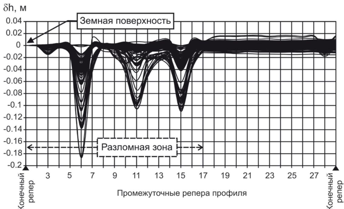
Рис. 1. Вертикальные смещения земной поверхности в зоне разлома по данным повторных геодезических наблюдений (Кузьмин, Чуриков, 1999)
