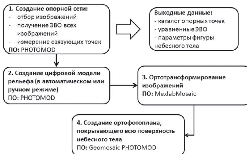
Рис. 3. Алгоритм создания ортофотоплана небесных тел
