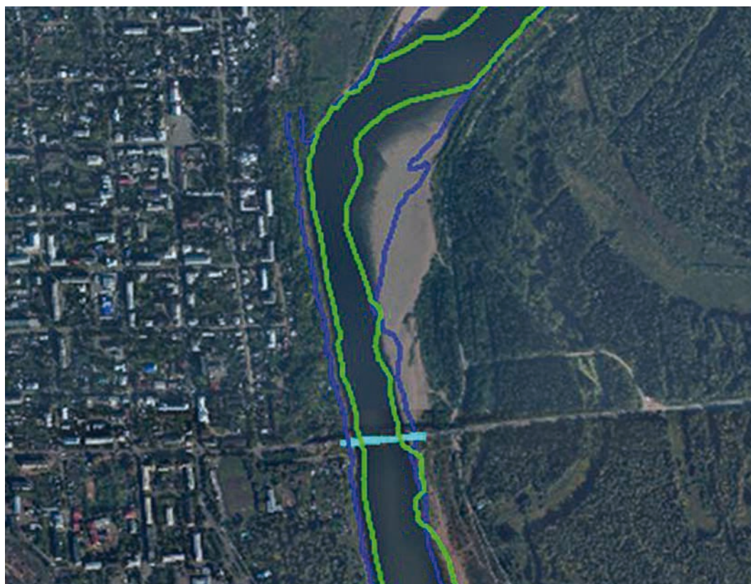
Рис. 1. Совмещенные планы русла за 1989 г. (синий цвет), 2011 г. (космоснимок) и прогнозируемое положение русла в 2030 г. (желтый цвет)
