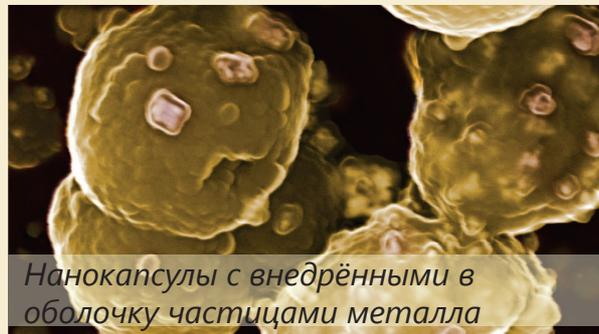
*Нанокapsулы с внедрёнными в оболочку частицами металла*
