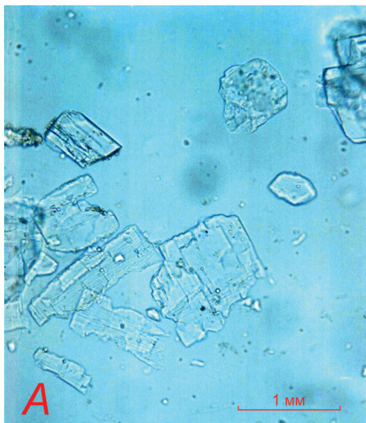
Рис. 5. Витчит, нерастворимый остаток водной вытяжки сильвин-галитовой породы, Сафроновский участок, скв. 4-С: А – без анализатора, Б – с анализатором
