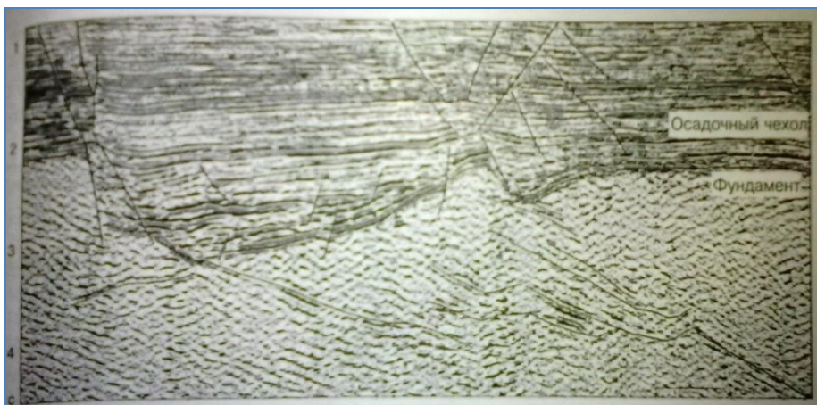
Рисунок 1 – Временной разрез, на котором прослеживается поверхность фундамента
